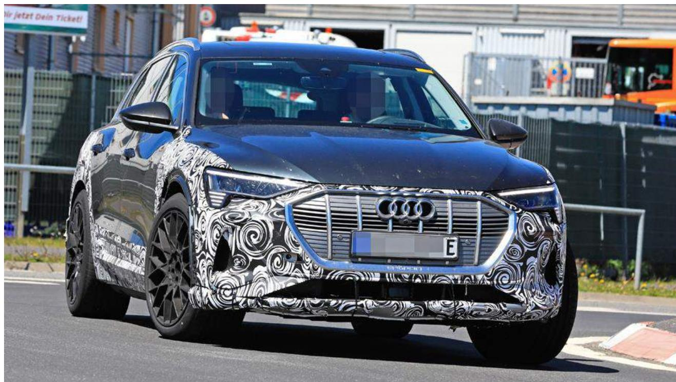
На тесты вышел не один прототип. На некоторых фото мы разглядели модель и марку шин (Bridgestone Alenza), а ещё оценили по снимкам посадочный диаметр — 22 дюйма (в нынешнем «и-троне» может быть 19 или 20 в зависимости от уровня комплектации или 21 дюйм в виде опции).
