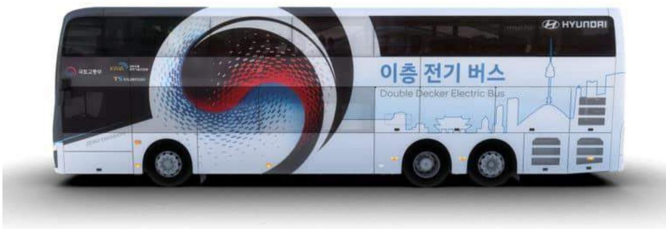
Трехосный электробус Hyundai длиной 13 метров и высотой 4 метра вмещает 70 пассажиров, при этом только 11 из них помещаются на нижнем этаже, тогда как все остальные — на верхнем. На нижнем этаже предусмотрено два места для пассажиров в инвалидных креслах, а также автоматическая рампа для облегчения посадки. Электробус даже оснащен автоматическими системами безопасности, включая удержание в полосе движения и экстренное торможение.
