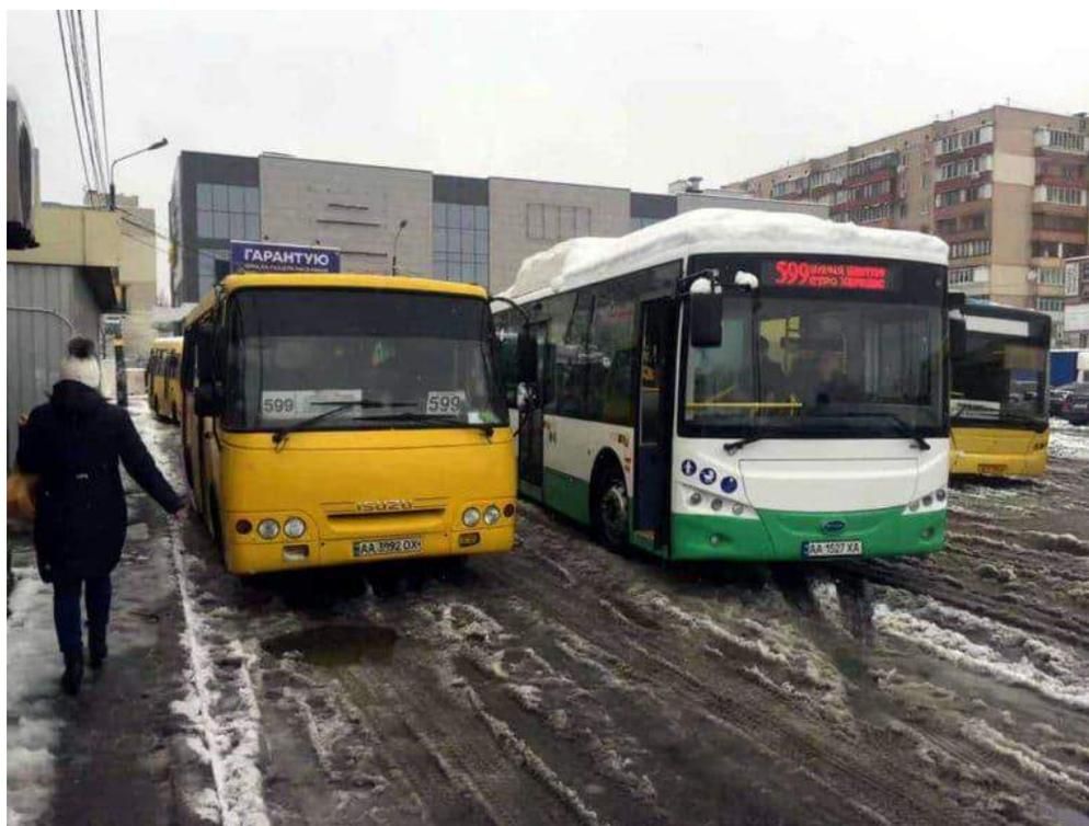
Во время испытаний была использована модель Skywell NJL 6129 BEV, оснащенного двигателем мощностью 200 кВт с крутящим моментом 2800 Нм и аккумуляторной батареей емкостью 276,4 кВтч. Максимальная скорость составляет 70 км/ч, запас хода — 300 км, время заряда с помощью фирменной зарядной станции — 3 часа.
