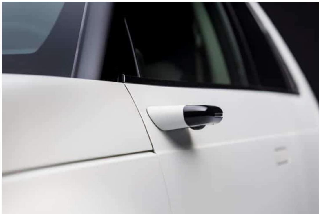
Японские инженеры отметили, что использование видеокамер вместо боковых зеркал помогает улучшить сразу несколько характеристик электромобиля, начиная с дизайна и эргономики и заканчивая безопасностью и аэродинамикой. Аналогичная система опционально используется в электромобилях Audi e-tron, однако в компактном классе она используется впервые.
